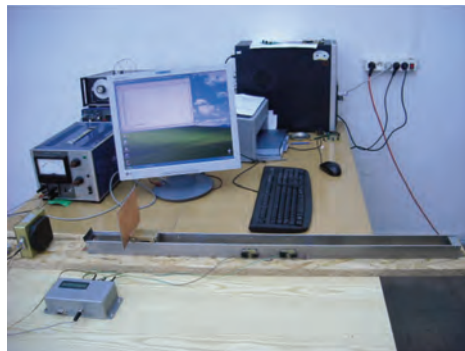
Rys. 6. Stanowisko do sprawdzenia prędkościomierza
