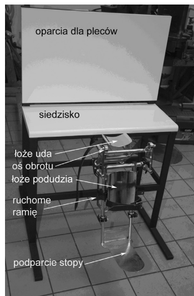
Rys. 1. Urządzenie do pomiaru napięcia mięśni kończyn dolnych pacjentów ze schorzeniami układu nerwowego [13, 16]
