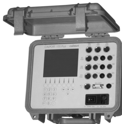
Rys. 4. Widok wejść testera liczników i przekładników
