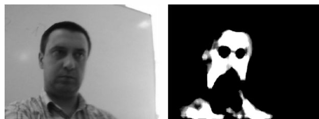
Fig. 4. Result of YCbCr mask (4) for skin detection Rys. 4. Wynik działania maski YcbCr (4) do detekcji twarzy
