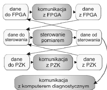
Rys. 6. Struktura programu procesora czasu rzeczywistego Fig. 6. Program structure of real-time processor
