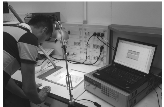
Rys. 3. Widok stanowiska pomiarowego do badania wpływu wahań napięcia na wybrane źródła promieniowania optycznego
