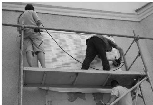
Rys. 2. Skanowanie powierzchni sgraffita za pomocą systemu GPR Fig. 2. Scan of sgraffito decoration surface by GPR system
