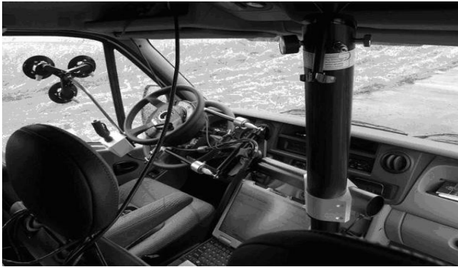
Rys. 8. System automatycznego kierowania pojazdem zamontowany w pojeździe Fig. 8. Automatic steering system in test vehicle
