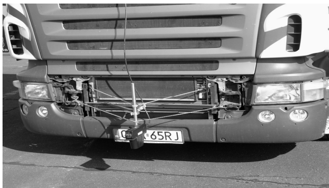
Rys. 1. Widok lampy służącej do pomiaru prędkości, typu Correvit Fig. 1. Show of speed measurement system - Correvit
