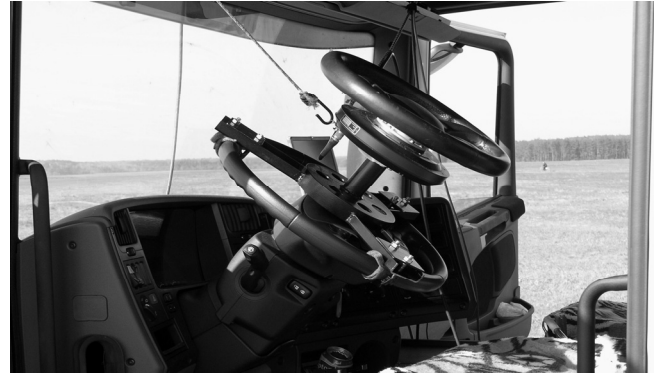
Rys. 2. Widok dodatkowej kierownicy umożliwiającej pomiar kąta i momentu wymuszenia realizowanego przez kierowcę
