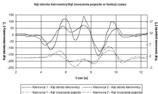
Rys. 7. Wykresy kąta obrotu kierownicy i kąta znoszenia pojazdu w funkcji czasu (wykres 3)
