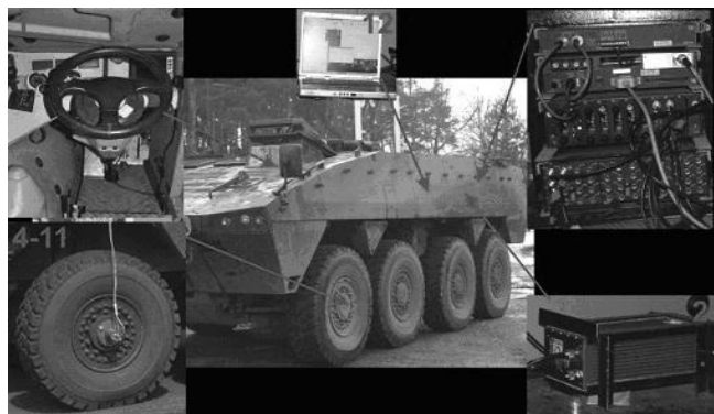
Rys. 4. Widok aparatury pomiarowej zamontowanej w opisywanym pojeździe KTO
