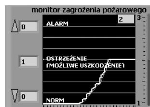
Rys. 4. Wykrycie uszkodzenia czujnika Fig. 4. Detection of the sensor damage
