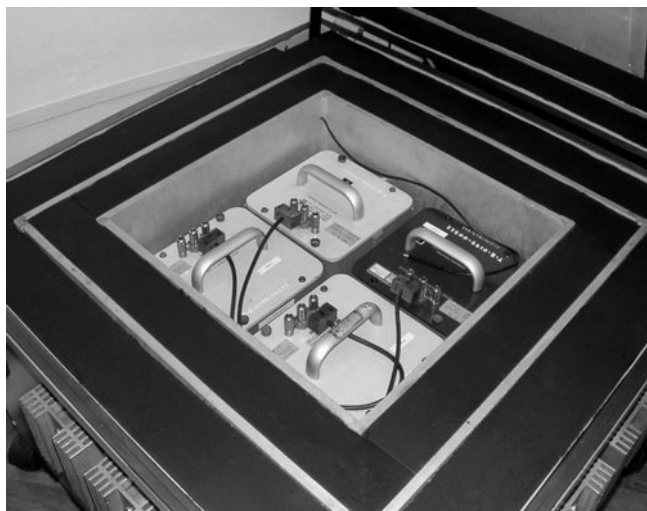
Rys. 1. Państwowy wzorec miary indukcyjności własnej w GUM: grupa czterech wzorców GR1482H wewnątrz termostatu powietrznego Fig. 1. The national primary inductance standard at the GUM: group of four GR1482H inductors in the thermostat
