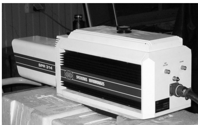
Rys. 1. Spektrometri podczerwieni SPR314 firmy GHG Fig. 1. Infrared spectrometer SPR 314 GHG
