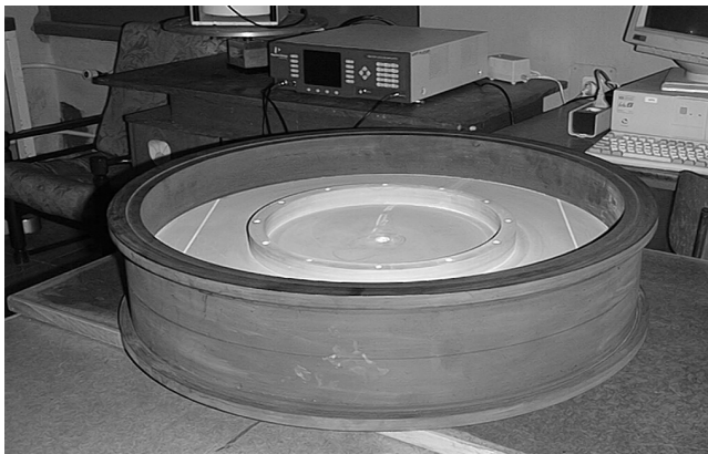
Rys. 2. Podłoże pętli światłowodowej Fig. 2. Base of the fiber loop
