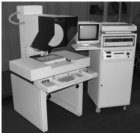
Rys. 6. Stanowisko do pomiarów odległości i kątów wyposażone w projektor pomiarowy typu OPTIMUS G IL firmy Schunk Werth Messtechnik Fig. 6. Stand for distance and angle measurements equipped with an OPTIMUS G IL projection gauge by Schunk Werth Messtechnik
