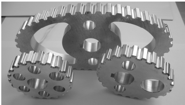
Rys. 2. Przykładowe nieokrągłe koła pasowe wykonane na uniwersalnej frezarce CNC
