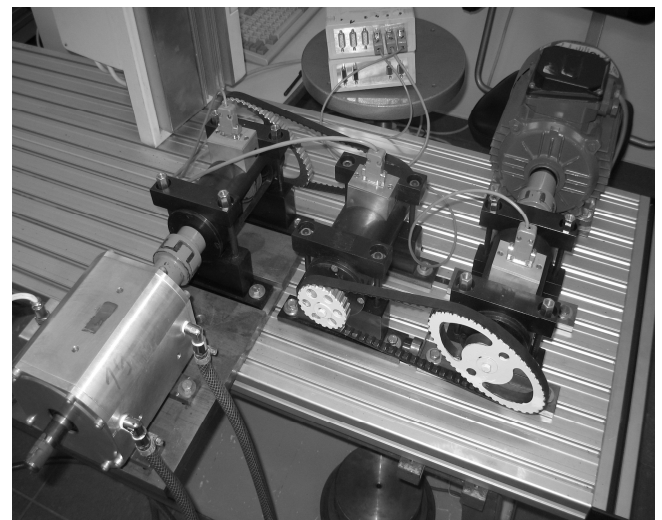
Rys. 1. Dwukołowa nierównobieżna przekładnia cięgnowa z pasem zębatym Fig. 1. Two pulleys uneven strand transmission with cog-belt
