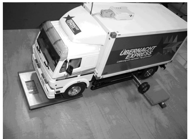
Rys. 9. Wyznaczanie środka masy metodą ważenia nacisków osi Fig. 9. Determination the mass centre by the axle load weighing method
