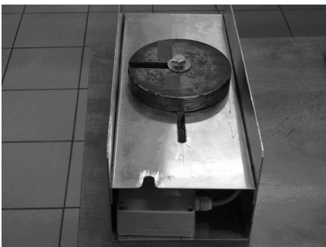
Rys. 7. Pojemnik z obciążnikiem do uzyskania położenia środka masy Fig. 7. Container with load to obtain the position of the mass centre
