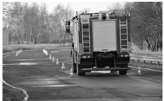
Rys. 5. Widok samochodu podczas testu pojedynczej zmiany pasa ruchu
