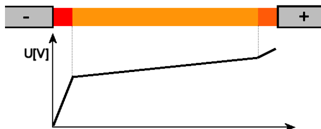
Rys. 7. Przebieg napięcia wzdłuż stałoprądowego wyładowania iskrowego na podstawie [104], [105]
