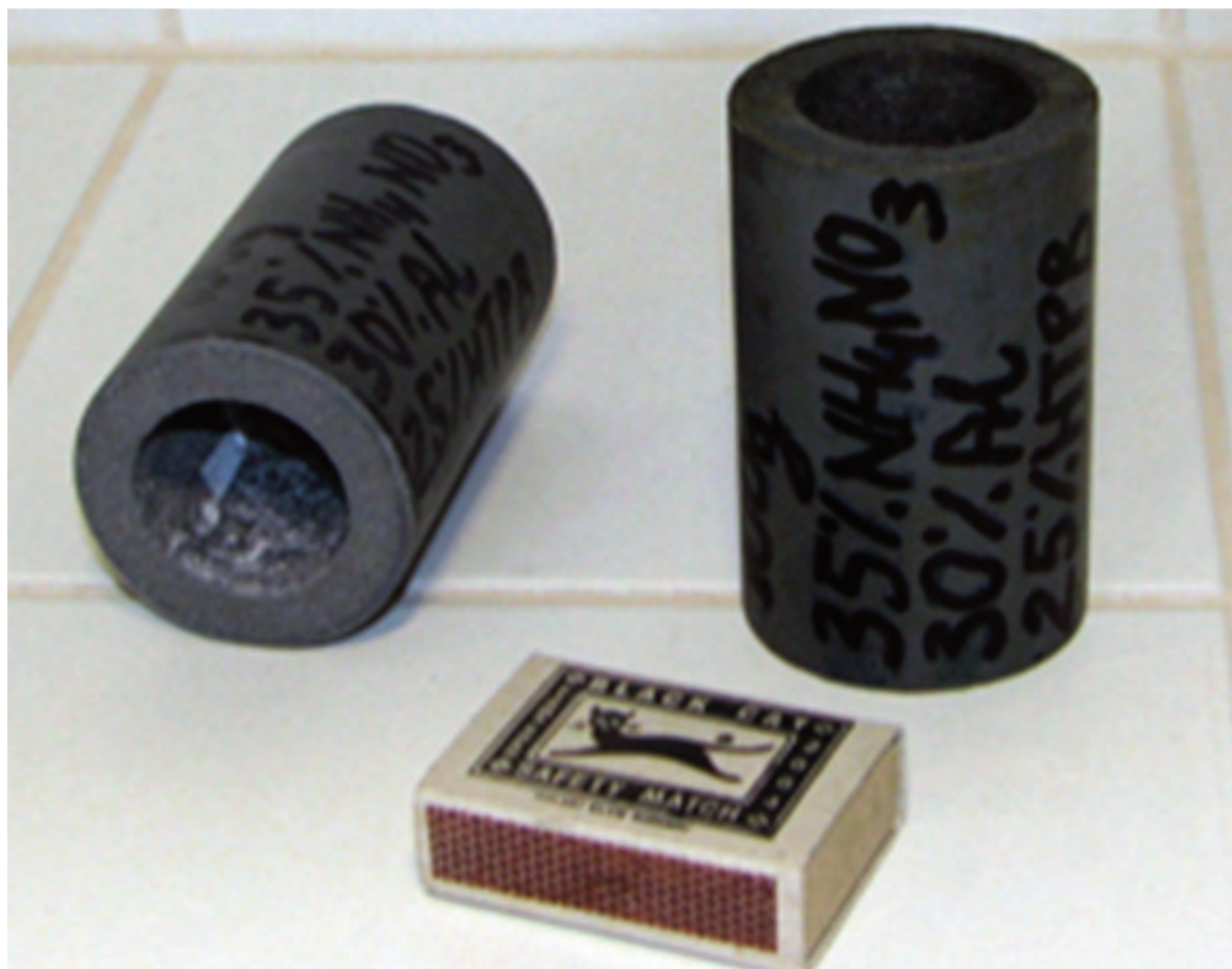
Rys. 11. Test silnika hybrydowego oraz materiał pędny użyty podczas badań
