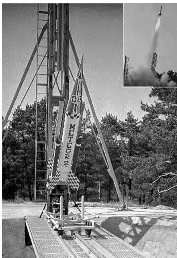
Rys. 3. Rakieta Meteor-2 przeznaczona do badania górnych warstw atmosfery, zbudowana w Instytucie Lotnictwa.
