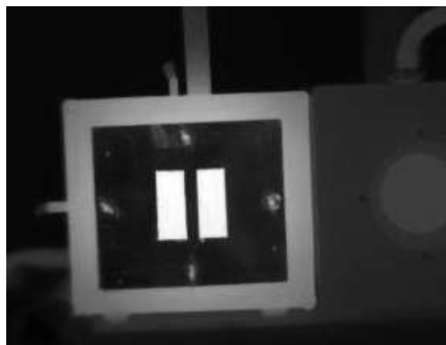
Fig. 4. Thermogram of plate covered with paint coats Rys. 4. Termogram płytki z naniesionymi powłokami farb
