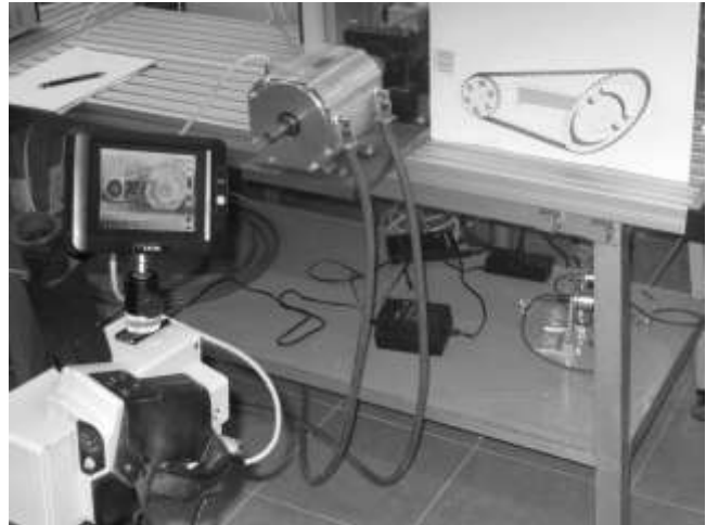
Fig. 2. Kit for researches of heat concentration in uneven strand transmission Rys. 2. Zestaw do badań koncentracji ciepła w nierównobieżnej przekładni ciągnawej
