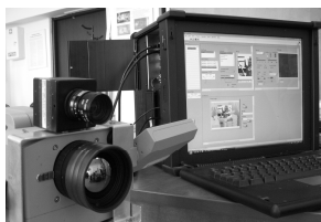
Rys. 3. Widok głowicy obserwacyjnej oraz serwera systemu z działającymi modułami programowymi do wizualizacji i rejestracji obrazów
