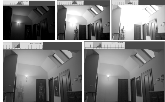
Rys. 6. Sekwencja LDR sceny dynamicznej oraz obrazy wynikowe dla metody konwencjonalnej (lewy) oraz prezentowanego podejścia (prawy) Fig. 6. LDR sequence for non-static scene, and corresponding HDR images: standard (left) and our approach (right)
