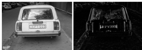
Rys. 1. Obraz oryginalny i jego mapa krawędzi [3] Fig. 1. Original and edge images [3]
