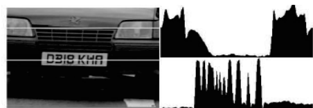
Rys. 2. Przykład lokalizacji tablicy przy pomocy sygnatur [4] Fig. 2. Example of license plate detection with signatures method [4]
