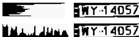
Rys. 3. Profile (lewa kolumna) wyliczone na podstawie zbinaryzowanej tablicy [4] Fig. 3. Profiles (left column) calculated on binarized image (right column) [4]
