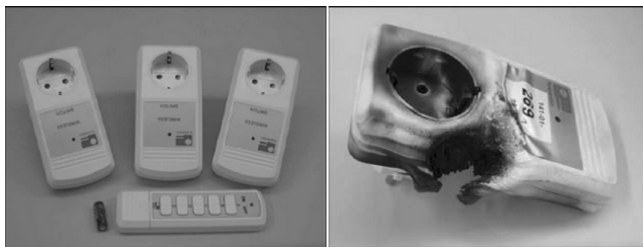
Rys. 3. Gniazdo elektryczne sterowane radiowo, uległo zapłonowi w trakcie badań prowadzonych przez laboratorium BNetzA w Kolbergu. Źródło: [10]
