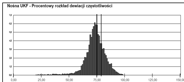
Rys. 2. Prezentacja graficzna wyniku pomiaru dewiacji częstotliwości (wynik negatywny)
