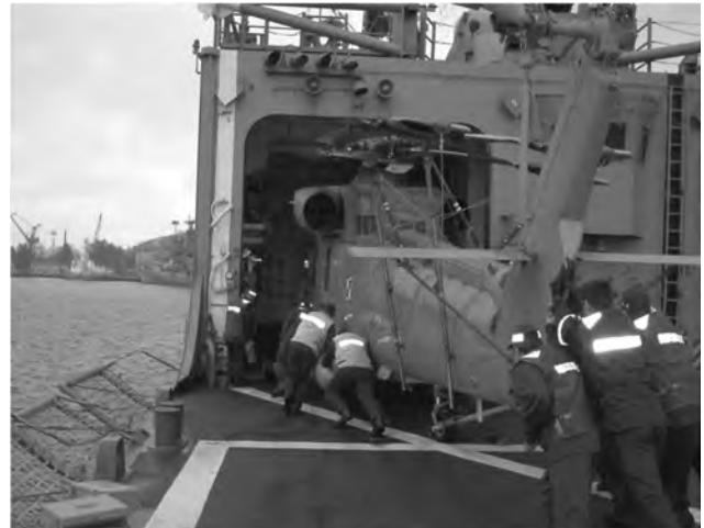
Fot. 9. SH-2G ze złożonymi łopatami WN i ŚO
