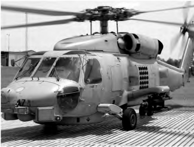
Fot. 6. SH-60B LAMPS Mk III Block I uzupełniony o głowicę FLIR
