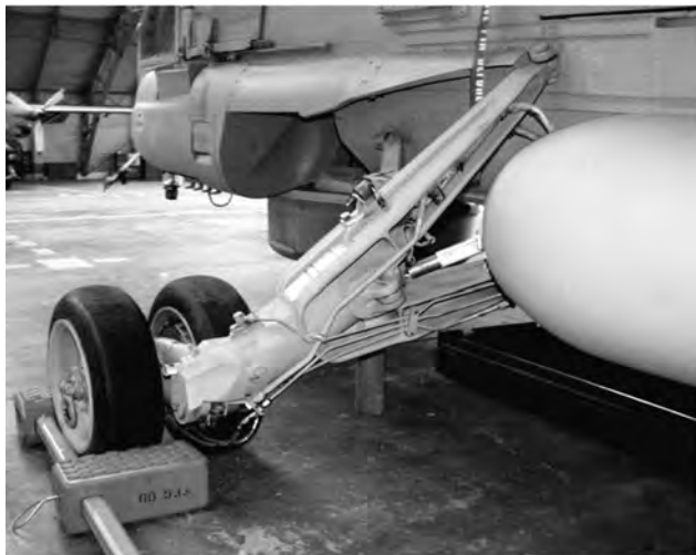
Fot. 11. SH-2G – lewa goleń podwozia głównego
