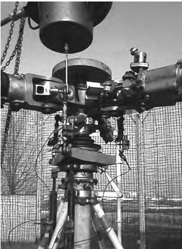
Rys. 3. Wzbudzenie drgań podczas badań rezonansowych „szywnego” ciągu sterowania
