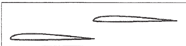
Rys. 1. Konfiguracja „L” wirnika współosiowego współbieżnego [2]
