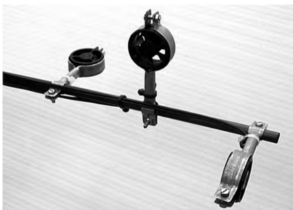
Rys. 4. Trzy anemometry mierzące trzy składowe prędkości powietrza
