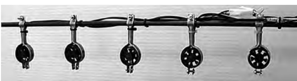
Rys. 5. Anemometry przygotowane do pomiaru profilu przepływu
