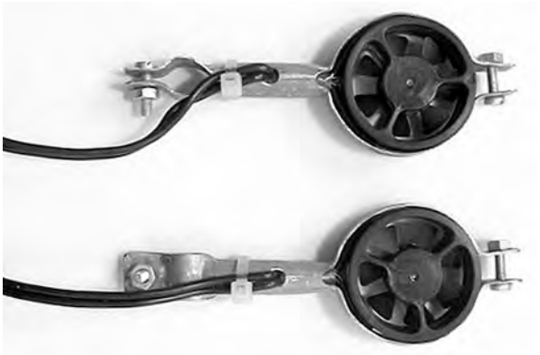
Rys. 2. Turbinki anemometrów zamocowane w oprawach różniących się kątem zamocowania ( 0^\circ i 90^\circ )
