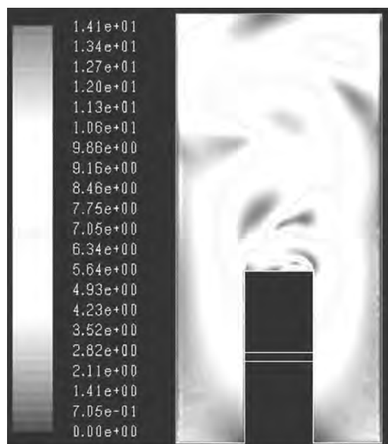
Rys. 17. Pole prędkości (m/s); y = 10
