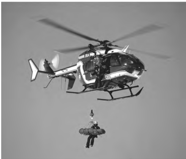
Fot. 4. Śmigłowiec Eurocopter EC-145 JBA Gendarmerie (Francja) w czasie akcji ratowniczej z wykorzystaniem wciągarki pokładowej zabudowanej nietypowo po prawej stronie kadłuba
