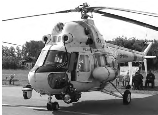
Fot. 1. Polski śmigłowiec PZL Kania z głowicą systemu obserwacyjnego i reflektorem ośniewającym
