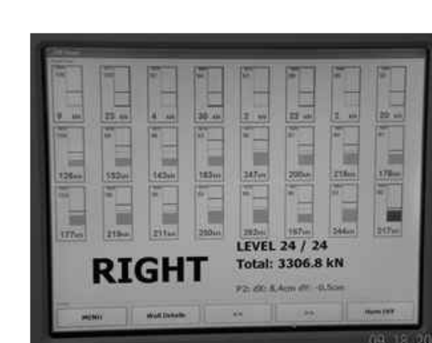
Rys. 6. Przebieg sumarycznego obciążenia zmierzonego na tle obciążenia modelowanego i wizualizacja w systemie FSSVisual
