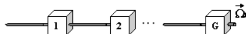
Rys. 2. Kaskada segmentów składających się z odcinka światłowodu i umieszczonego za nim skramblera polaryzacji
