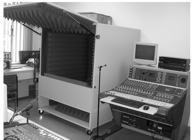
Rys. 1. Stanowisko do pomiaru charakterystyki kierunkowości przetworników elektroakustycznych (Laboratorium Podstaw Elektroakustyki)
