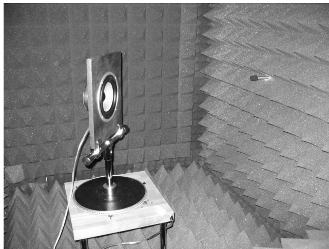
Rys. 4. Wnętrze komory bezchowej do pomiaru charakterystyki kierunkowości głośnika
