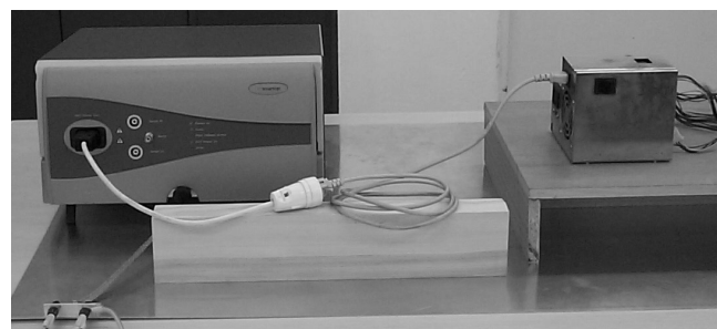
Rys. 1. Stanowisko laboratoryjne do badań odporności urządzeń elektronicznych na zaburzenia BURST i SURGE
