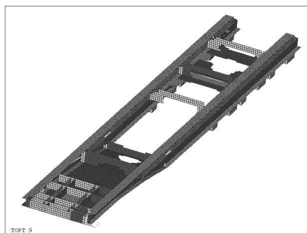
Rys. 4. Wyniki optymalizacji topologicznej Fig. 4. The results of topology optimization
