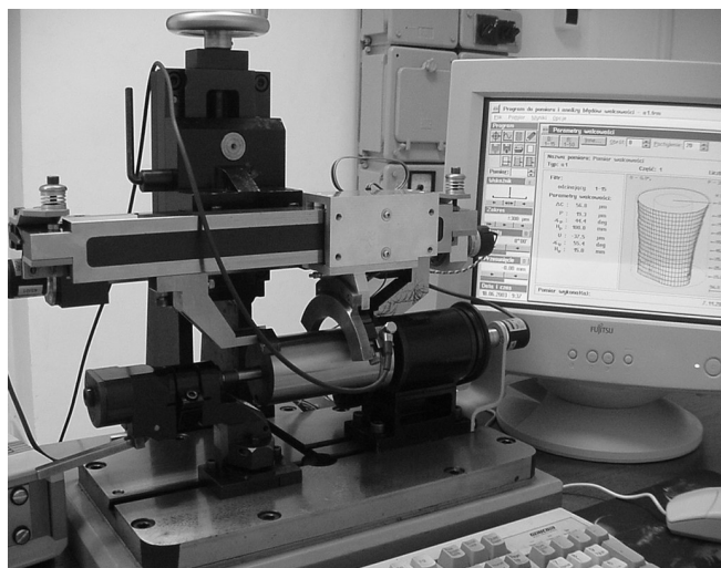
Rys. 1. Modelowe stanowisko badawcze PSA 6 do pomiarów walcowości metodą odniesieniową
