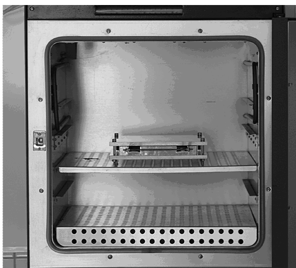
Rys. 2. Blok aluminiowy umieszczony wewnątrz sterylizatora SP-65G z grawitacyjnym obiegiem powietrza Fig. 2. Aluminium unit placed inside gravity convection air oven SP-65G
