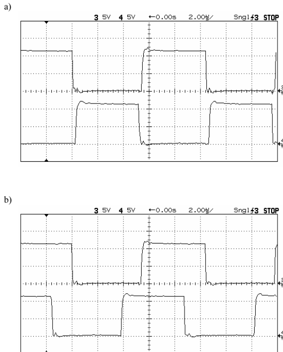
Fig. 4.1. Driving signals for main transistor T1 – CH3 (upper) and auxiliary transistor Ta1 – CH4 (lower): a) \vartheta_{on} = \pi , b) \vartheta_{on} = \frac{\pi}{3} Rys. 4.1. Sygnał sterujący tranzystor główny T1 – CH3 (górnny) oraz tranzystor pomocniczy Ta1 – CH4 (dolny): a) \vartheta_{on} = \pi , b) \vartheta_{on} = \frac{\pi}{3}
