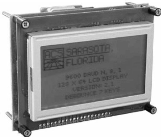
Rys.2. Wyświetlacz ciekłokrystaliczny modułu pomiarowego Fig. 2. Display of measurement module
