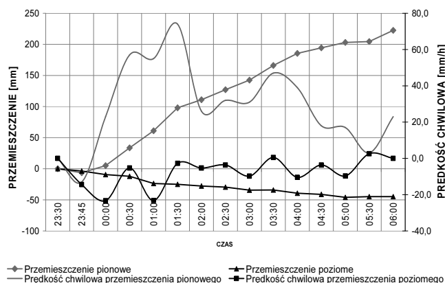
Rys. 7. Przemieszczenia wybranego kompensatora podczas odstawienia kotła Fig. 7. Displacements of chosen compensator during boiler shutdown
