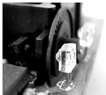
Rys. 5. Zasada działania enkodera optycznego Fig. 5. Principle of optical encoder operation
