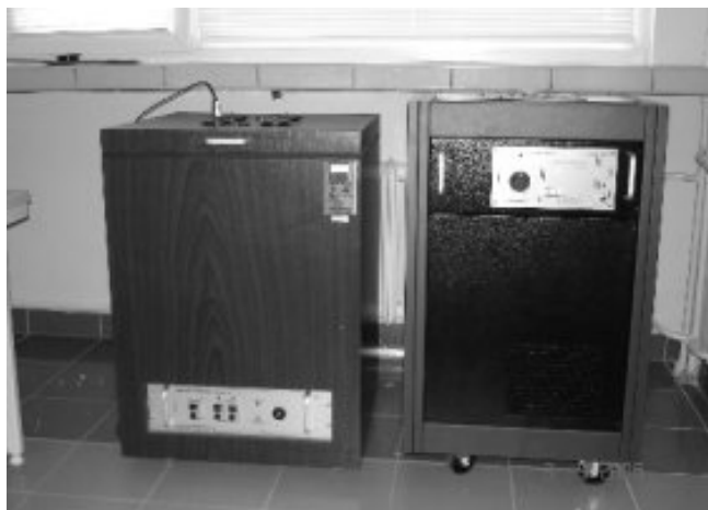
Rys. 1. Wanny/termostaty do realizacji punktu potrójnego wody i rtęci Fig. 1. Bath for realization triple point of water and mercury
