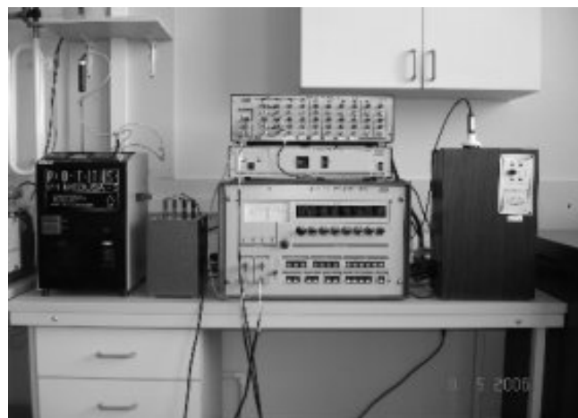
Rys. 2. Stanowisko do wzorcowania termometrów w punkcie krzepnięcia indu i topnienia galu Rys. 2. Stand for calibration thermometers in fixed points of indium and gallium
