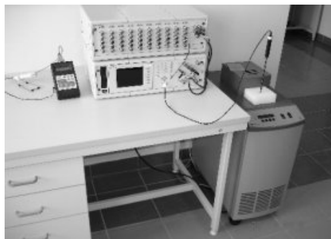
Rys. 3. Stanowisko do wzorcowania termometrów elektrycznych w zakresie od -80 °C do 100 °C metodą porównawczą Fig. 3. Stand for calibration of electrical thermometers in temperature range from -80 °C to +100 °C
