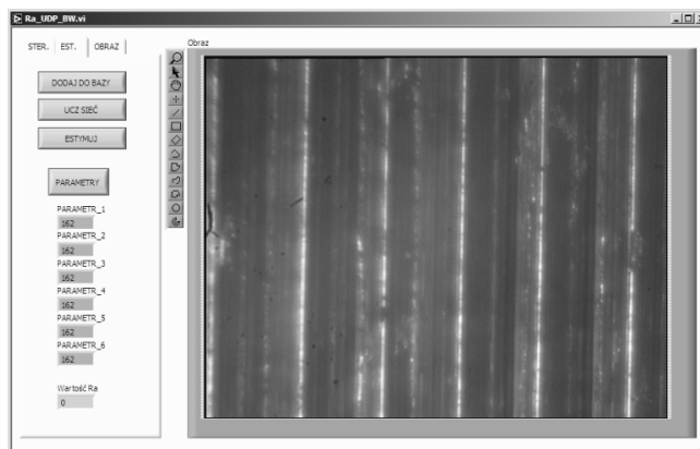
Rys. 5. Interfejs użytkownika a) do sterowania jakością obrazu, b) do estymacji wartości parametrów obrazu i parametru R_a chropowatości powierzchni
