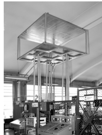
Rys. 12. Wzorzec pola elektrycznego w Katedrze Elektroenergetyki AGH według wymagań normy PN-IEC 833:1997
