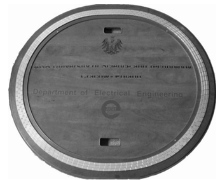
Rys. 16. Tor magnetyczny do badań i demonstracji lewitacji magnetycznej z wykorzystaniem nadprzewodnika wysokotemperaturowego
