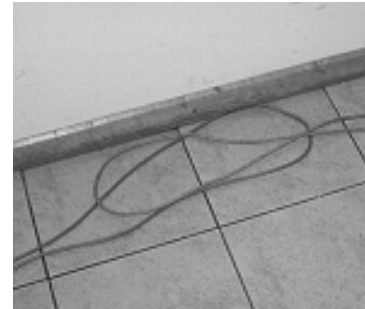
Rys. 5. Skrzyżowanie kabli umożliwiające transmisję PLC Fig. 5. Wiring crossing that enables PLC transmission between wires
