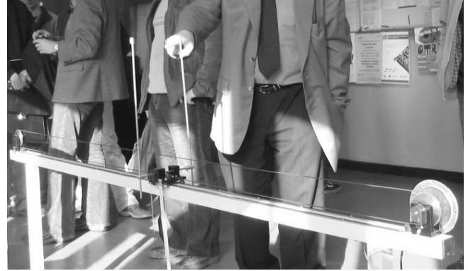
Rys. 24. Stabilizowany system wahałda na wózku (w górnym niestabilnym punkcie równowagi) jest odporny na zakłócenie Fig. 24. The stabilized pendulum-cart system in an upright unstable equilibrium point is robust while disturbed by a finger
