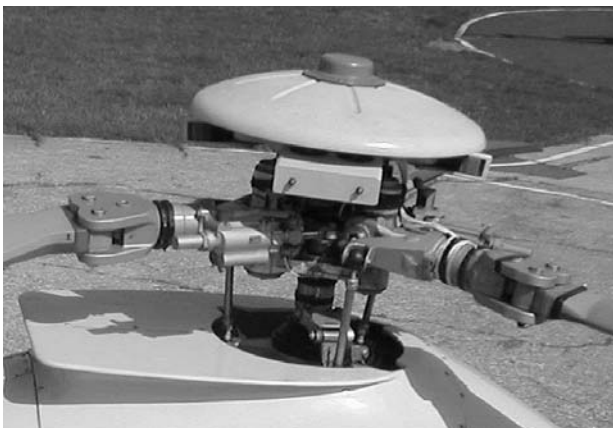
Antywibrator bifilarny zamontowany na głowicy wirnika nośnego śmigłowca SW-4
