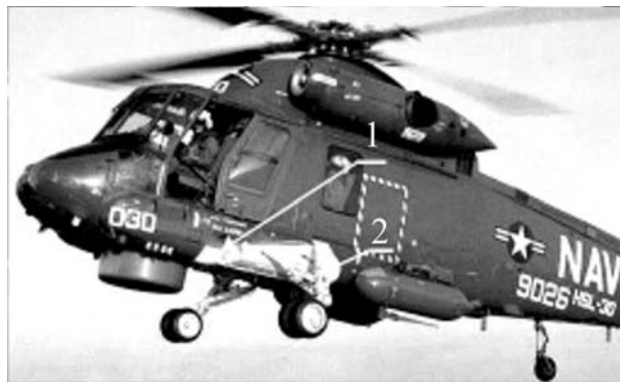
Rys. 4. Podwozie półchowane i z goleniami składanymi do przodu. 1 - miejsce w kadłubie na koła wraz z goleniami, 2 - mechanizmy chowania i wypuszczania podwozia
