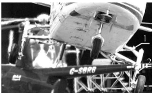
Rys. 3. Podwozie kołowe całkowicie chowane do kadłuba 1 - silownik mechanizmu chowania, 2 - amortyzator podwozia głównego
